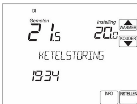
Figuur 7: Basisscherm kamerthermostaat met storingsindicatie
